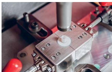
Durch Ultraschallschweißen wird die Membrane, welche für die Luftdosierung und -reinigung verantwortlich ist, aufgeschweisst.
