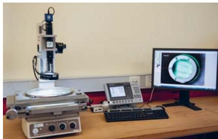
Der Lichtleiter wird auf dem Messmikroskop ausgemessen und mittels Durchlicht die optische Qualität überprüft.
