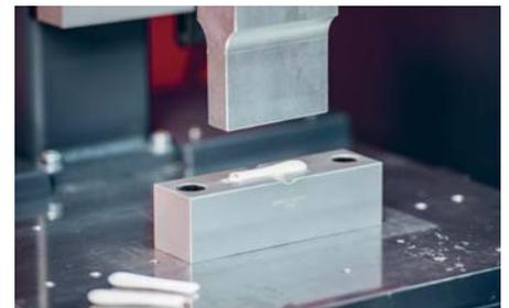
Zwei identische Bauteile werden mittels Ultraschall zu einer Schutzkappe verschweisst.
