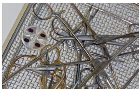
Der kippstichergestaltete Sensor zeigt die Reinigungsqualität des Spülvorgangs an.
