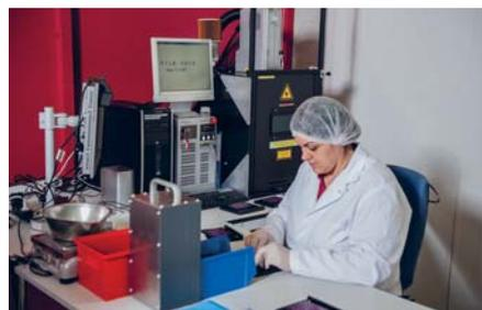
Damit die Proben im Labor eindeutig identifizierbar sind, werden die Caps mittels Laser codiert.
