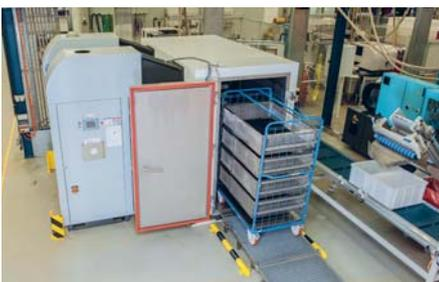
Durch das Konditionieren wird die mehrmonatige Wasseraufnahme im Kunststoff innerhalb weniger Stunden realisiert.
