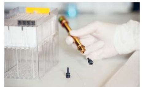
Die Glastubes werden mit den codierten Caps versehen und anschliessend zu Racks mit 96 Probenröhrchen konfektioniert.
